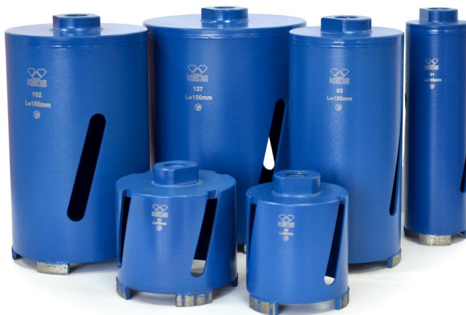
Алмазные коронки KEOS предназначены для бурения слабоармированного бетона, кирпича, натурального камня. Имеют посадку M16 и используются как на стационарных станках, так и на перфораторах (алмазные коронки для перфоратора). Алмазный сегмент приварен к корпусу лазером, что позволяет осуществлять бурение без подачи воды.
