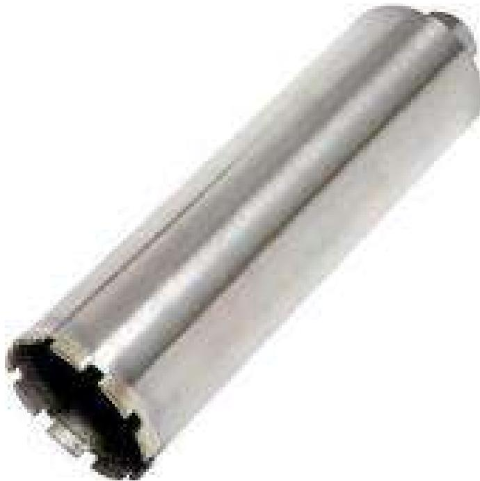
Коронки для алмазного бурения выполнены в виде стальной трубы. С одной стороны у нее располагается хвостовик, соответствующий ключу на 41 мм, а другой находятся алмазные сегменты, нанесенные посредством серебра. Такие коронки применяются только при «мокром» бурении. Это объясняется тем, что без постоянной подачи воды серебро начинает плавиться. В результате коронки быстро изнашиваются из-за разрушения алмазных сегментов.
