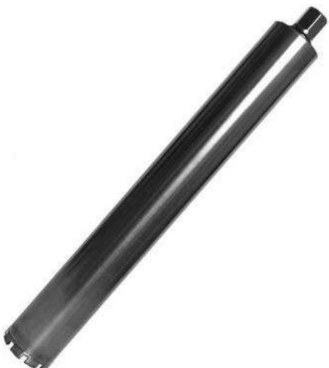
Коронки для алмазного бурения выполнены в виде стальной трубы. С одной стороны у нее располагается хвостовик, соответствующий ключу на 41 мм, а другой находятся алмазные сегменты, нанесенные посредством серебра. Такие коронки применяются только при «мокром» бурении. Это объясняется тем, что без постоянной подачи воды серебро начинает плавиться. В результате коронки быстро изнашиваются из-за разрушения алмазных сегментов.
