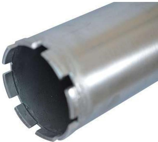
Алмазные коронки SPX для сверления бетона с арматурой (обязательно с водяным охлаждением). Ресурс алмазного сегмента от 6 до 10 метров. Скорость сверления в бетоне 2,5 см в 1 минуту. Длина корпуса от 300 мм до 500 мм. Предназначена для сверления железобетона, бетона, кирпича и тд. Эффективно работает на установках для алмазного сверления мощностью от 1,6 КВт до 4 КВт
