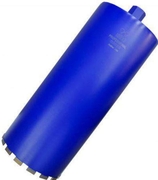
Алмазные коронки с лазерной сваркой KEOS PRO, производство Южная Корея. Самый распространенный случай, когда требуются такие коронки, это возможность сверления без подачи воды (чистовая отделка, например). Такой способ напайки сегментов к корпусу исключает отрыв сегмента. В случае, если применен способ пайки серебром, то сверление такими коронками без воды не желательно. Так как при нагреве сегменты могут отпасть от корпуса. Кроме того, сверление без воды значительно сокращает ресурс сегментов.
