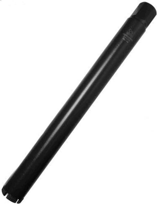
Коронки для алмазного бурения выполнены в виде стальной трубы. С одной стороны у нее располагается хвостовик, соответствующий ключу на 41 мм, а другой находятся алмазные сегменты, нанесенные посредством серебра. Такие коронки применяются только при «мокром» бурении. Это объясняется тем, что без постоянной подачи воды серебро начинает плавиться. В результате коронки быстро изнашиваются из-за разрушения алмазных сегментов.
