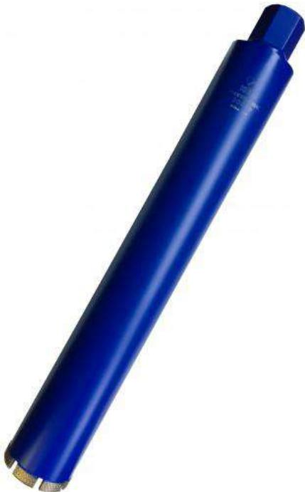
Алмазные коронки с лазерной сваркой KEOS PRO, производство Южная Корея. Самый распространенный случай, когда требуются такие коронки, это возможность сверления без подачи воды (чистовая отделка, например). Такой способ напайки сегментов к корпусу исключает отрыв сегмента. В случае, если применен способ пайки серебром, то сверление такими коронками без воды не желательно. Так как при нагреве сегменты могут отпасть от корпуса. Кроме того, сверление без воды значительно сокращает ресурс сегментов.
