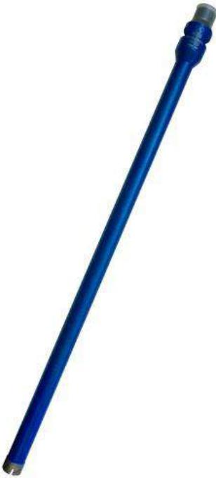
Алмазные коронки с лазерной сваркой KEOS PRO, производство Южная Корея. Самый распространенный случай, когда требуются такие коронки, это возможность сверления без подачи воды (чистовая отделка, например). Такой способ напайки сегментов к корпусу исключает отрыв сегмента. В случае, если применен способ пайки серебром, то сверление такими коронками без воды не желательно. Так как при нагреве сегменты могут отпасть от корпуса. Кроме того, сверление без воды значительно сокращает ресурс сегментов.
