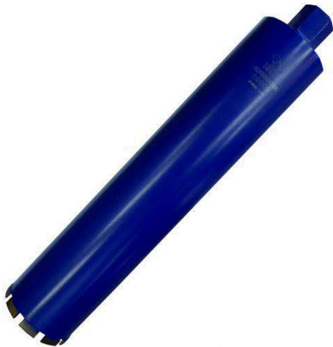
Алмазные коронки с лазерной сваркой KEOS PRO, производство Южная Корея. Самый распространенный случай, когда требуются такие коронки, это возможность сверления без подачи воды (чистовая отделка, например). Такой способ напайки сегментов к корпусу исключает отрыв сегмента. В случае, если применен способ пайки серебром, то сверление такими коронками без воды не желательно. Так как при нагреве сегменты могут отпасть от корпуса. Кроме того, сверление без воды значительно сокращает ресурс сегментов.
