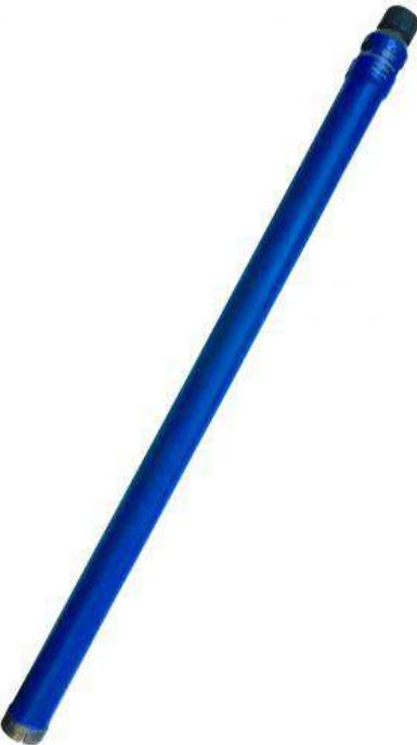
Алмазные коронки с лазерной сваркой KEOS PRO, производство Южная Корея. Самый распространенный случай, когда требуются такие коронки, это возможность сверления без подачи воды (чистовая отделка, например). Такой способ напайки сегментов к корпусу исключает отрыв сегмента. В случае, если применен способ пайки серебром, то сверление такими коронками без воды не желательно. Так как при нагреве сегменты могут отпасть от корпуса. Кроме того, сверление без воды значительно сокращает ресурс сегментов.
