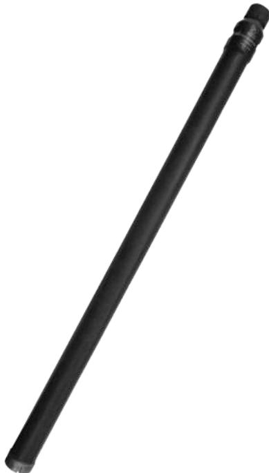
Коронки для алмазного бурения выполнены в виде стальной трубы. С одной стороны у нее располагается хвостовик, соответствующий ключу на 41 мм, а другой находятся алмазные сегменты, нанесенные посредством серебра. Такие коронки применяются только при «мокром» бурении. Это объясняется тем, что без постоянной подачи воды серебро начинает плавиться. В результате коронки быстро изнашиваются из-за разрушения алмазных сегментов.
