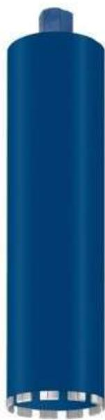
Коронки для алмазного бурения выполнены в виде стальной трубы. С одной стороны у нее располагается хвостовик, соответствующий ключу на 41 мм, а другой находятся алмазные сегменты, нанесенные посредством серебра. Такие коронки применяются только при «мокром» бурении. Это объясняется тем, что без постоянной подачи воды серебро начинает плавиться. В результате коронки быстро изнашиваются из-за разрушения алмазных сегментов.
