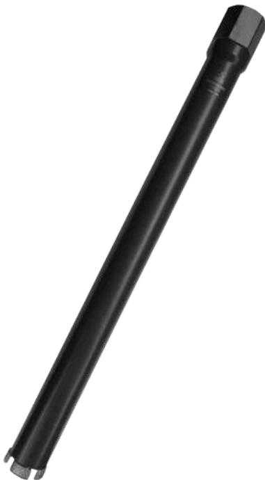
Коронки для алмазного бурения выполнены в виде стальной трубы. С одной стороны у нее располагается хвостовик, соответствующий ключу на 41 мм, а другой находятся алмазные сегменты, нанесенные посредством серебра. Такие коронки применяются только при «мокром» бурении. Это объясняется тем, что без постоянной подачи воды серебро начинает плавиться. В результате коронки быстро изнашиваются из-за разрушения алмазных сегментов.
