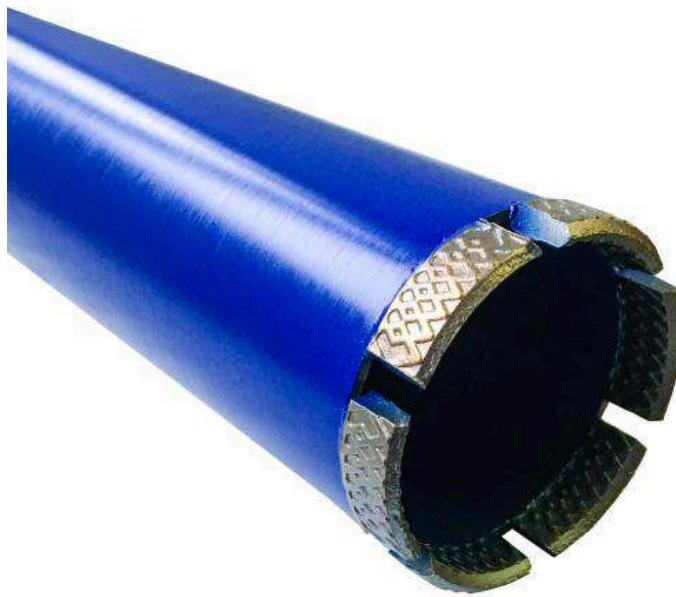
Алмазные коронки с лазерной сваркой KEOS PRO, производство Южная Корея. Самый распространенный случай, когда требуются такие коронки, это возможность сверления без подачи воды (чистовая отделка, например). Такой способ напайки сегментов к корпусу исключает отрыв сегмента. В случае, если применен способ пайки серебром, то сверление такими коронками без воды не желательно. Так как при нагреве сегменты могут отпасть от корпуса. Кроме того, сверление без воды значительно сокращает ресурс сегментов.
