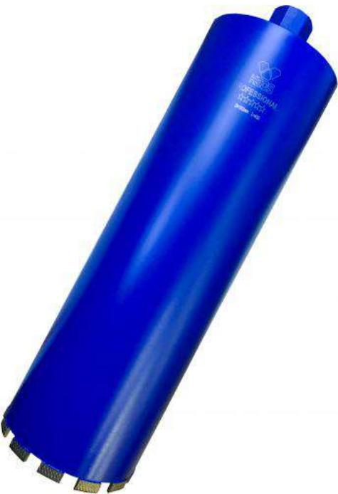
Алмазные коронки с лазерной сваркой KEOS PRO, производство Южная Корея. Самый распространенный случай, когда требуются такие коронки, это возможность сверления без подачи воды (чистовая отделка, например). Такой способ напайки сегментов к корпусу исключает отрыв сегмента. В случае, если применен способ пайки серебром, то сверление такими коронками без воды не желательно. Так как при нагреве сегменты могут отпасть от корпуса. Кроме того, сверление без воды значительно сокращает ресурс сегментов.
