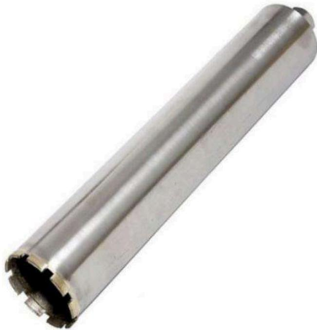
Коронки для алмазного бурения выполнены в виде стальной трубы. С одной стороны у нее располагается хвостовик, соответствующий ключу на 41 мм, а другой находятся алмазные сегменты, нанесенные посредством серебра. Такие коронки применяются только при «мокром» бурении. Это объясняется тем, что без постоянной подачи воды серебро начинает плавиться. В результате коронки быстро изнашиваются из-за разрушения алмазных сегментов.
