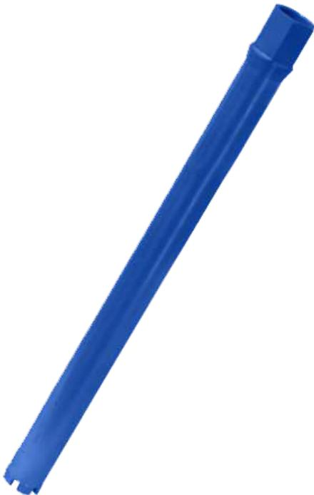
Коронки для алмазного бурения выполнены в виде стальной трубы. С одной стороны у нее располагается хвостовик, соответствующий ключу на 41 мм, а другой находятся алмазные сегменты, нанесенные посредством серебра. Такие коронки применяются только при «мокром» бурении. Это объясняется тем, что без постоянной подачи воды серебро начинает плавиться. В результате коронки быстро изнашиваются из-за разрушения алмазных сегментов.
