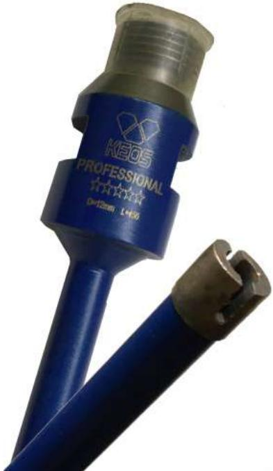
Алмазные коронки с лазерной сваркой KEOS PRO, производство Южная Корея. Самый распространенный случай, когда требуются такие коронки, это возможность сверления без подачи воды (чистовая отделка, например). Такой способ напайки сегментов к корпусу исключает отрыв сегмента. В случае, если применен способ пайки серебром, то сверление такими коронками без воды не желательно. Так как при нагреве сегменты могут отпасть от корпуса. Кроме того, сверление без воды значительно сокращает ресурс сегментов.
