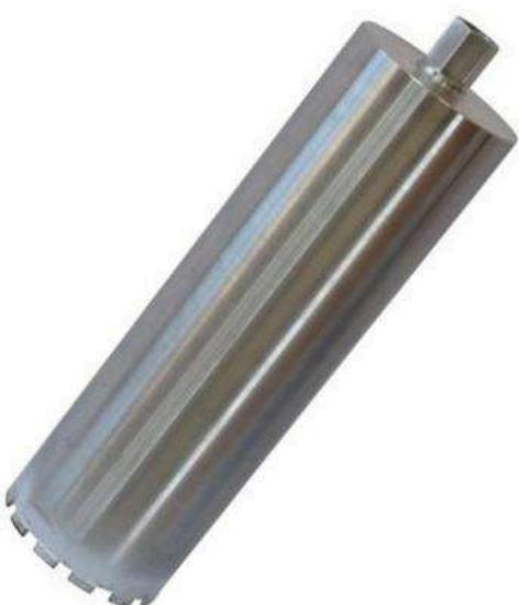
Коронки для алмазного бурения выполнены в виде стальной трубы. С одной стороны у нее располагается хвостовик, соответствующий ключу на 41 мм, а другой находятся алмазные сегменты, нанесенные посредством серебра. Такие коронки применяются только при «мокром» бурении. Это объясняется тем, что без постоянной подачи воды серебро начинает плавиться. В результате коронки быстро изнашиваются из-за разрушения алмазных сегментов.
