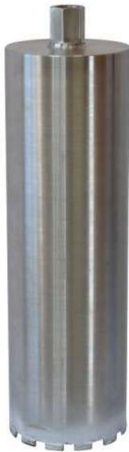
Коронки для алмазного бурения выполнены в виде стальной трубы. С одной стороны у нее располагается хвостовик, соответствующий ключу на 41 мм, а другой находятся алмазные сегменты, нанесенные посредством серебра. Такие коронки применяются только при «мокром» бурении. Это объясняется тем, что без постоянной подачи воды серебро начинает плавиться. В результате коронки быстро изнашиваются из-за разрушения алмазных сегментов.
