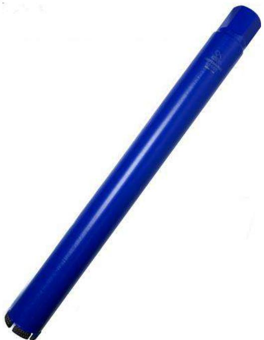
Алмазные коронки с лазерной сваркой KEOS PRO, производство Южная Корея. Самый распространенный случай, когда требуются такие коронки, это возможность сверления без подачи воды (чистовая отделка, например). Такой способ напайки сегментов к корпусу исключает отрыв сегмента. В случае, если применен способ пайки серебром, то сверление такими коронками без воды не желательно. Так как при нагреве сегменты могут отпасть от корпуса. Кроме того, сверление без воды значительно сокращает ресурс сегментов.
