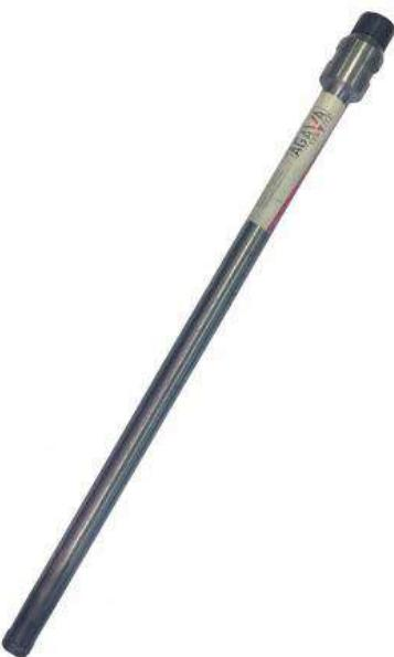
Коронки для алмазного бурения выполнены в виде стальной трубы. С одной стороны у нее располагается хвостовик, соответствующий ключу на 41 мм, а другой находятся алмазные сегменты, нанесенные посредством серебра. Такие коронки применяются только при «мокром» бурении. Это объясняется тем, что без постоянной подачи воды серебро начинает плавиться. В результате коронки быстро изнашиваются из-за разрушения алмазных сегментов.
